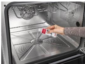
Foto 4: Ein eigens von Miele entwickelter Flüssigreiniger wird in das Sieb am Geräteboden eingefüllt, sodann automatisch mit frischem Wasser vermischt, zur Garraumdecke gepumpt und von dort über ein Flügelrad im Garraum gleichmässig versprüht. (Foto: Miele)
